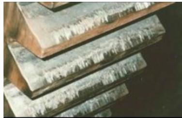
**Le grippage** est une avarie liée à un contact métal/métal lors de l'engrènement entraînant un arrachement de matière. Les grippages apparaissent en cas de rupture du film lubrifiant. Ils peuvent être localisés en un point précis, sur les zones de glissement uniquement ou enfin sur toute la surface.
