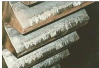
**Le grippage** est une avarie liée à un contact métal/métal lors de l'engrènement entraînant un arrachement de matière. Les grippages apparaissent en cas de rupture du film lubrifiant. Ils peuvent être localisés en un point précis, sur les zones de glissement uniquement ou enfin sur toute la surface.
